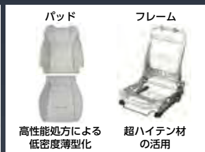
軽量シートの開発 将来の燃費規制や電動化に伴う軽量化ニーズへの対応 軽量効果の大きいフレームとパッドで目標20%軽減 (現行シート完成品比)
