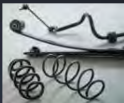
自動車用懸架ばね 燃費向上・省スペース化を目的に、 軽量化されたばね
