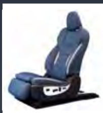
軽量シートの開発 将来の燃費規制や電動化に伴う軽量化ニーズへの対応 軽量効果の大きいフレームとパッドで目標20%軽減 (現行シート完成品比)
