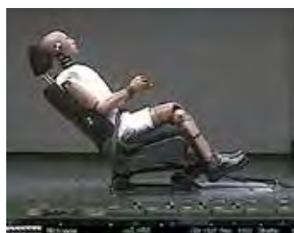
自動車用シート油圧式スレッド試験による安全性評価
