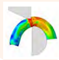
コイルばね切断時の 応力分布 【加工解析】
