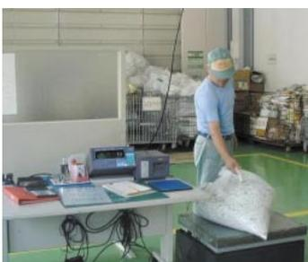
廃棄物に貼付されたバーコードを読み込み、種類と量を排出部署ごとに自動的に集計します。データは各部署の排出量の管理と減量化、そしてコスト意識の向上に役立っています。
